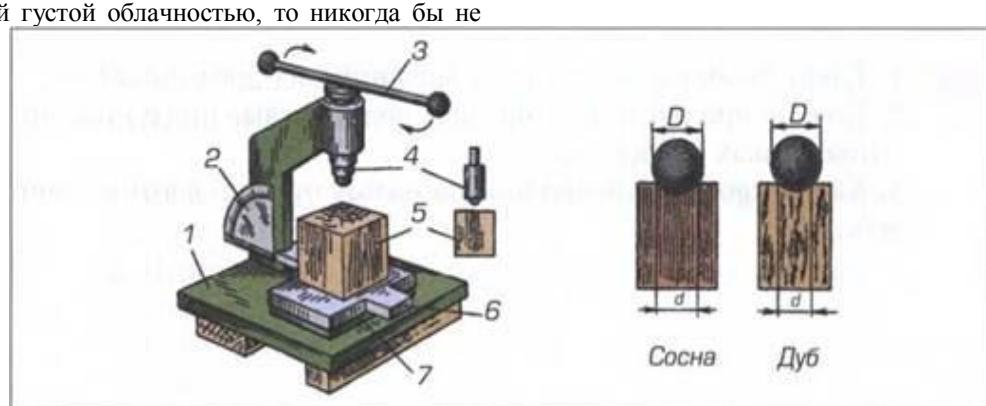
Рис.1. Прибор для измерения твердости древесины
